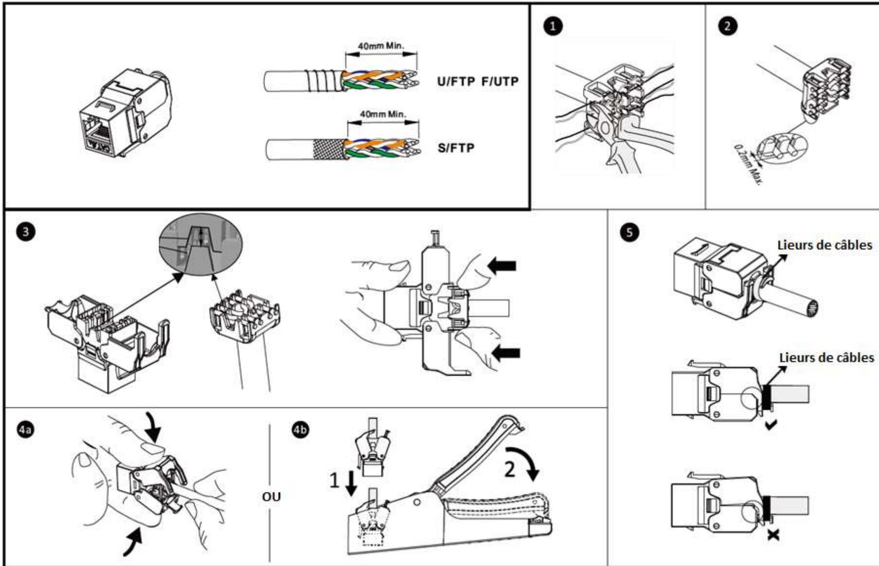
La fiche accouplée doit être conforme à la norme IEC 60603-7.
